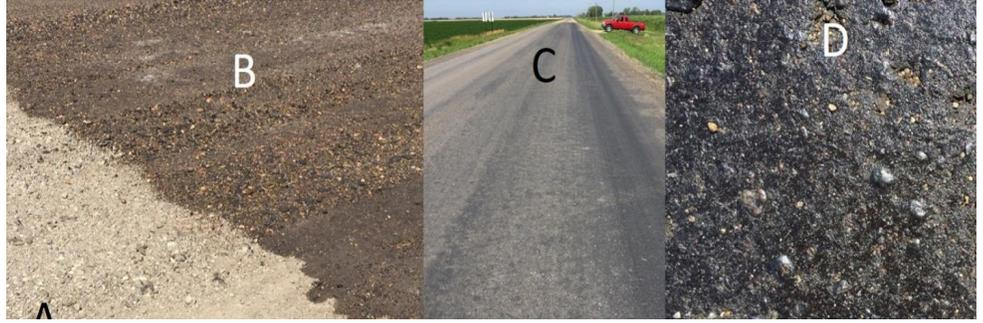
A) Gravier non traité. B) 30 minutes après le traitement C) Après six semaines D) Vue rapprochée de la surface d'une route traitée. (Test réel effectué sur du gravier avec un mélange composé à 25 % d'asphalte broyé).
